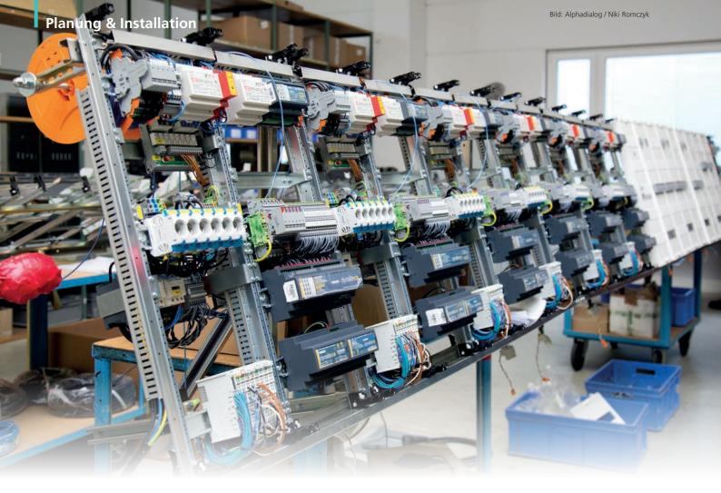
Topjob-S-Reihenklemmen von Wago: Basis moderner Sicherheitsbeleuchtungssysteme
